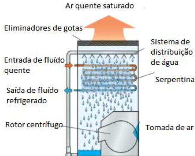
**Figura 4 - Torre de resfriamento de circuito fechado – Catálogo EVAPCO (2020)**
