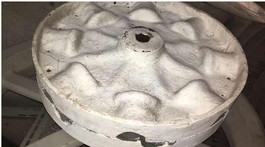
**Figura 9 - Cubo para fixação das pás – Autor (2021)**
