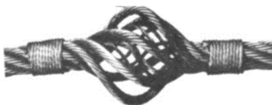
Figura 31 – Fenômeno Birdcaging (Fonte: Costello, 1990).
