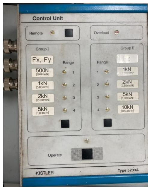
Figura 35 - Condicionador de sinais Kistler modelo 5233 A
