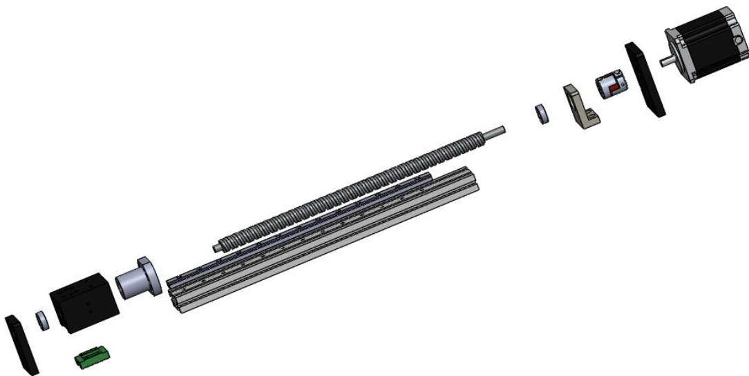
Figura 23: Vista explodida da guia linear FSL40 Fonte: RAFAEL SOBRINHO (2021)
