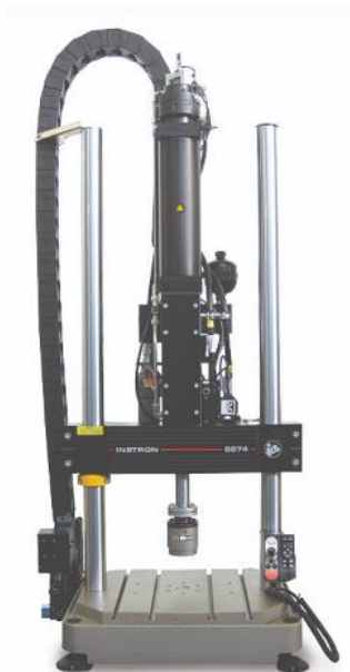
Figura 10: Máquina capaz de realizar o ensaio de fadiga de tração-compressão e ensaio de fadiga de torção Fonte: CATÁLOGO INSTRON (2020)
