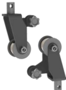
Figura 12: Garra para fios em ensaios de fadiga
