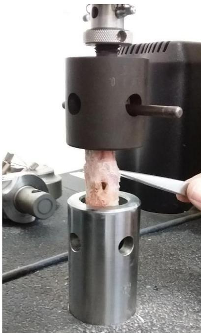
Figura 16 - LCP sendo posicionado nas garras da INSTRON
