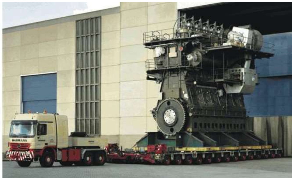
Figura 25 - Wärtsilä-Sulzer 14RT-flex96C (Fonte: Site autotecnica.band.uol.com.br)
