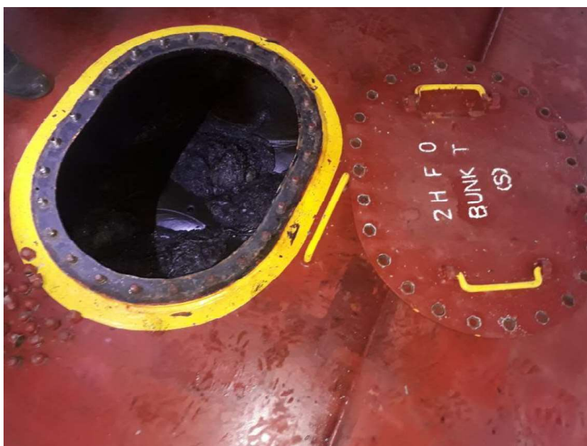
Figura 43 - Combustível que perdeu a estabilidade após mistura de bunkers, resultando na precipitação e aglomeração de moléculas de asfalteno (Fonte: Ship and Bunker website , 2020)
