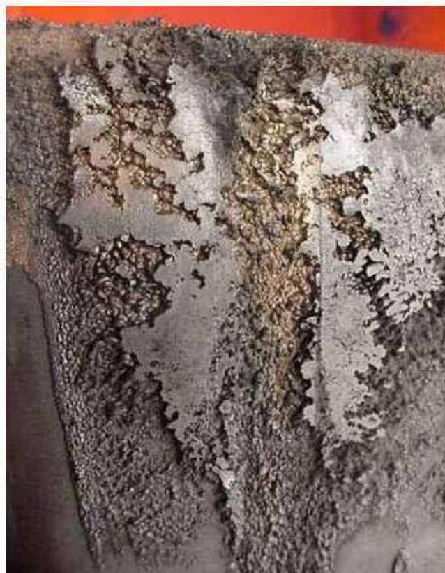
Figura 38 – Detalhe da figura 37, mostrando a formação de depósitos no topo do pistão (Fonte: Considerations for using low-sulphur fuel, Wartsila, 2002)
