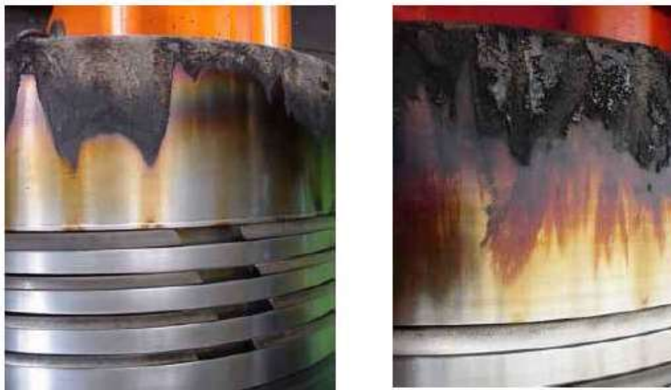
Figura 37 – Pistão que utilizou lubrificante BN 70 por algumas horas de operação (Fonte: Considerations for using low-sulphur fuel, Wartsila, 2002)
