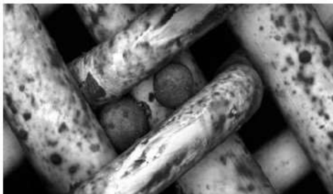
Figura 49 - Fotografia microscópica de finos catalíticos presos na malha de um filtro de combustível (Fonte: MAN Diesel, 2013)
