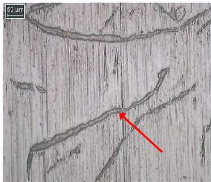
Figura 46 - Visão microscópica de uma camisa de cilindro de ferro fundido (Fonte: MAN Diesel, 2013)
