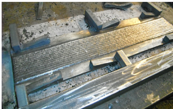
Figura 3: Revestimento de soldagem por deposição através do processo arame tubular
