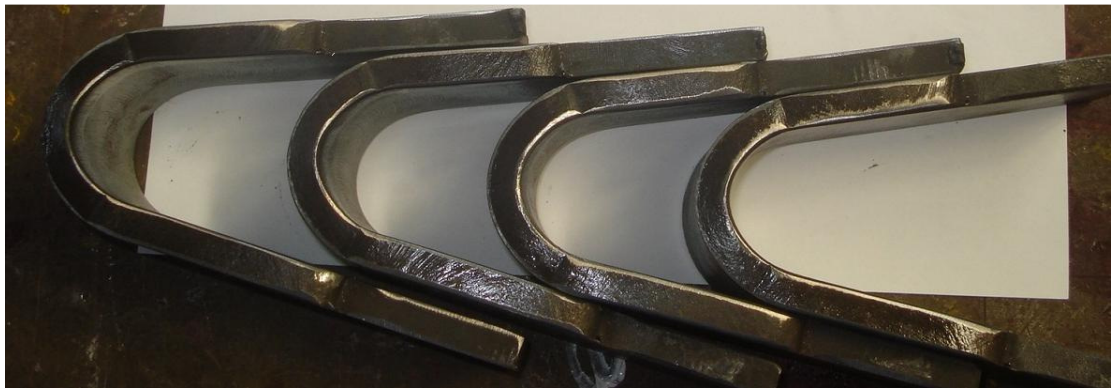
Figura 34: Corpos de prova resultantes do ensaio de dobramento
