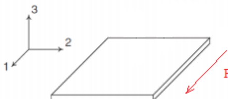
Figura 11: Modo de operação d31. Fonte: adaptado de Yang et al, (2018).
