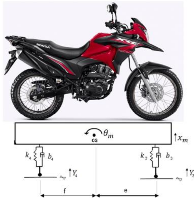
Figura 19: Representação dinâmica da moto (Adaptado de HONDA, 2020)
