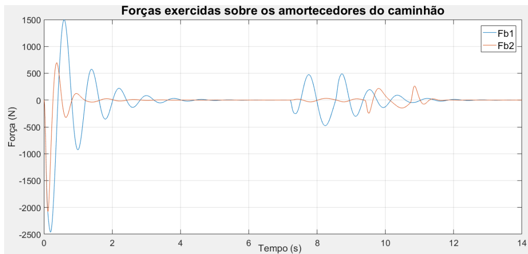
Figura 35: Forças exercidas sobre os amortecedores do caminhão no modelo acoplado
