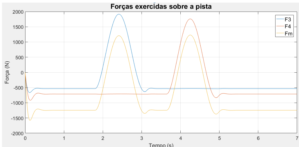
Figura 30: Forças que as rodas da moto exercem sobre a pista
