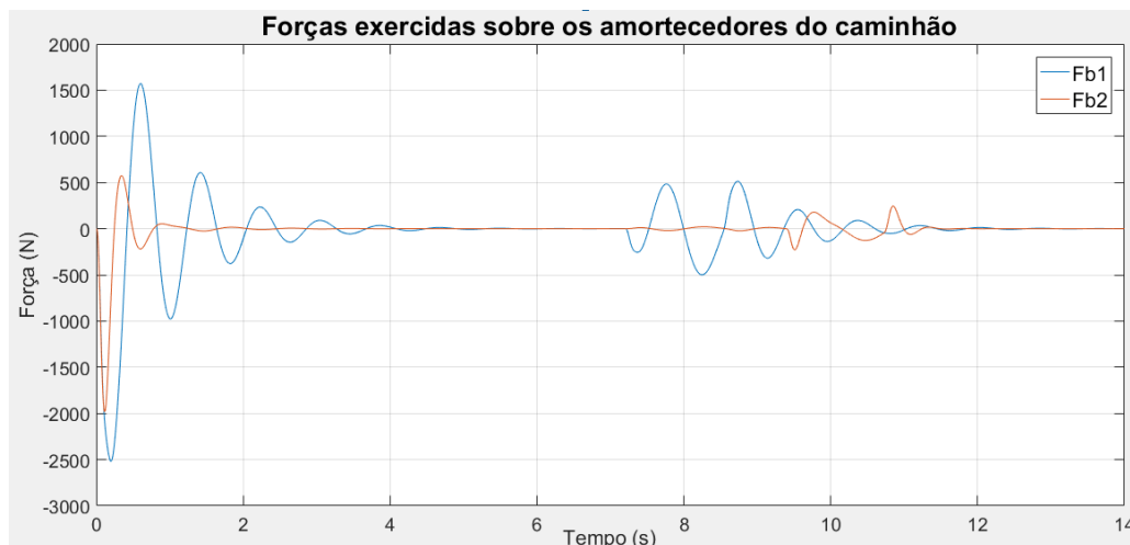
Figura 44: Forças exercidas sobre os amortecedores do caminhão no modelo acoplado descentralizado
